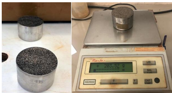
Figura 3.13 – Cápsulas de controle de compactação
