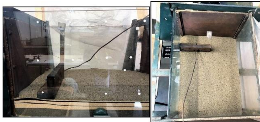
Figura 3.15 – Posicionamento da ancoragem no módulo de ensaio
