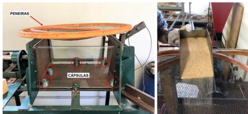
Figura 3.12 – Controle de compactação e pluviamento de areia
