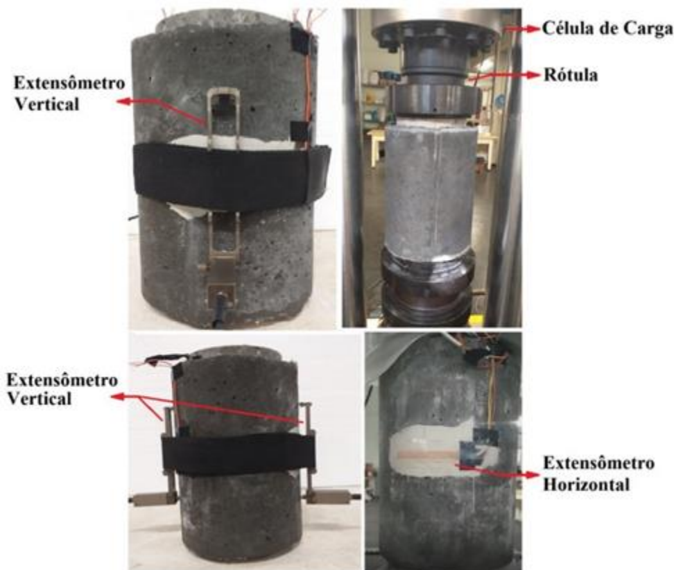
Figura 5.30 – Configuração de ensaio dos Modelos de estudo
