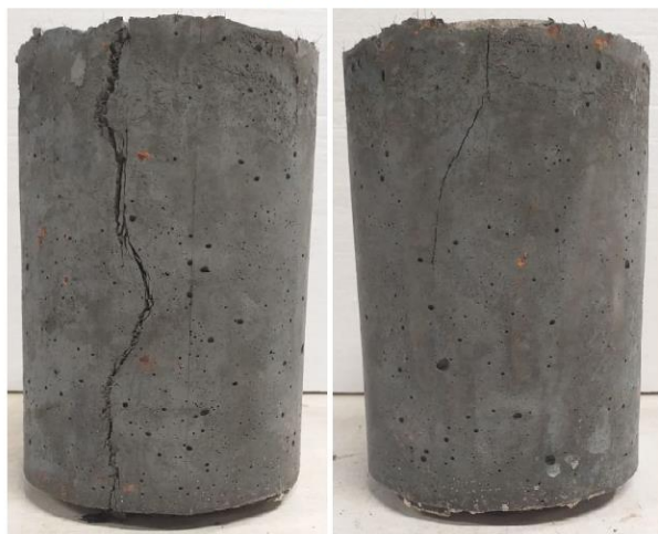
Figura B.0.1 – Modelos com C25 e 2,5cm de reforço
