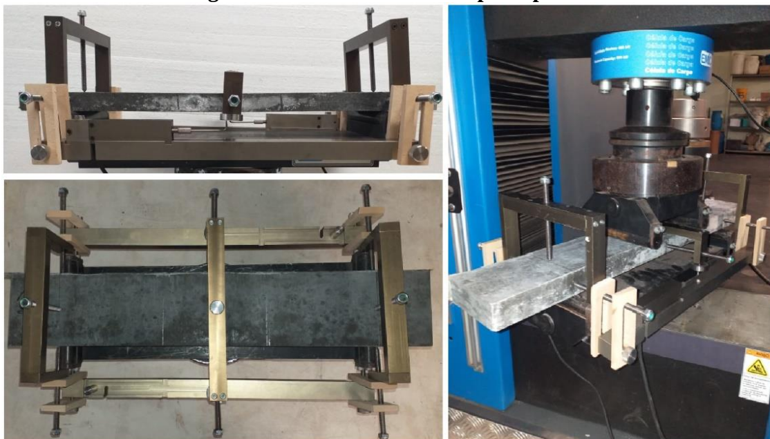
Figura 5.16 – Ensaio de flexão por 4 pontos
