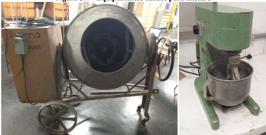
Figura 5.4 – Equipamentos usados para mistura
