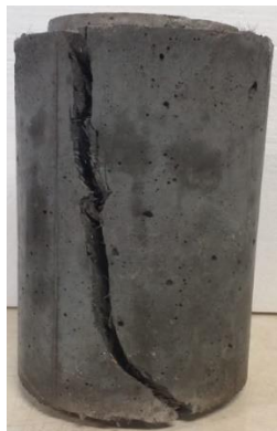
Figura 6.1 – Padrão de fissura da camisa de UHPFRC
