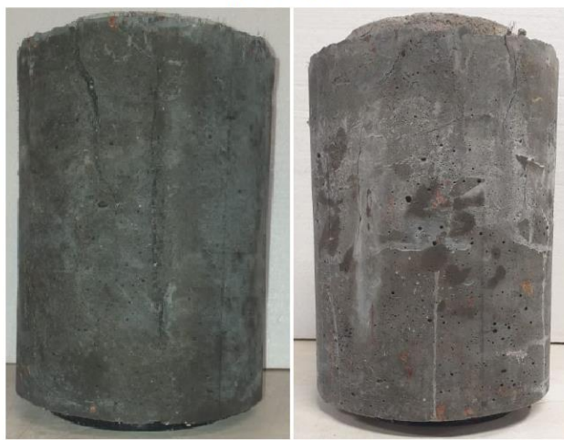
Figura B.0.1 – Modelos com C25 e 2,5cm de reforço
