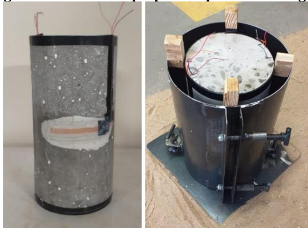
Figura 5.10 – Núcleo preparado para concretagem
