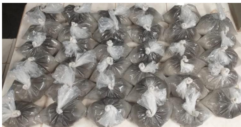
Figura 5.9 - Materiais pré-misturados para 1 concretagem
