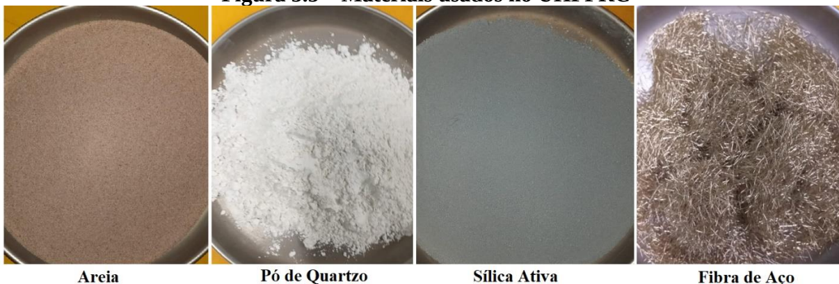
Figura 5.5 – Materiais usados no UHPFRC
