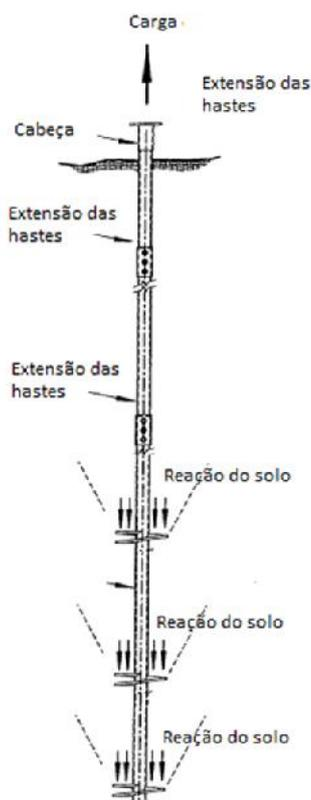
Figura 11 – Interação estaca helicoidal solo
