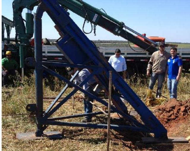
Figura 25 – Tripé para aplicação das cargas axiais da estaca
