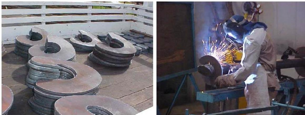
Figura 6 a) hélices b) soldagem das hélices no eixo
