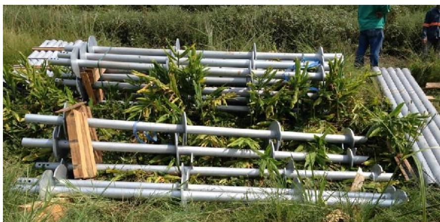
Figura 7 - Estacas helicoidais
