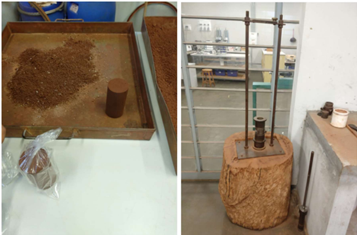
Figura 22 - Confeção dos corpos de prova
