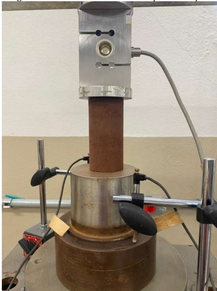
Figura 25 - Ensaio de resistência à compressão simples.
