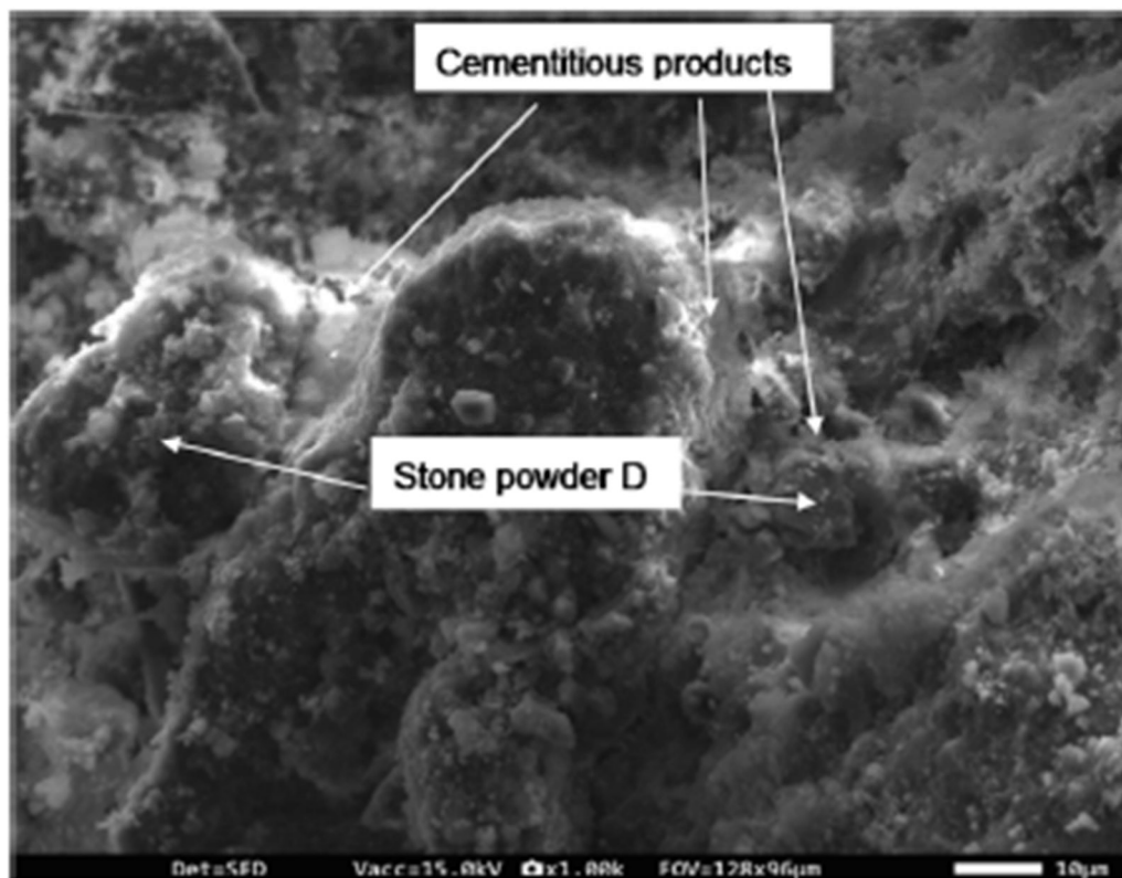
Figura 11 - Microscopia com grãos de pó de pedra
