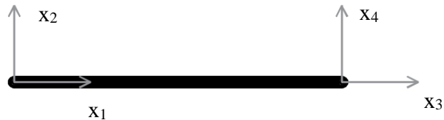
Figura 4.3 – Graus de liberdade de um elemento finito de treliça
