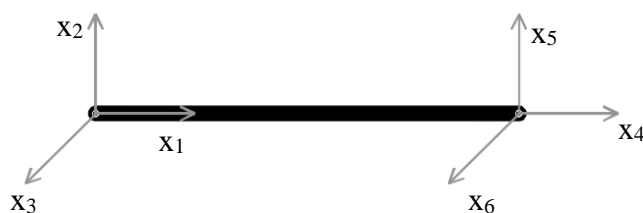
Figura 4.5 – Graus de liberdade de um elemento finito de treliça
