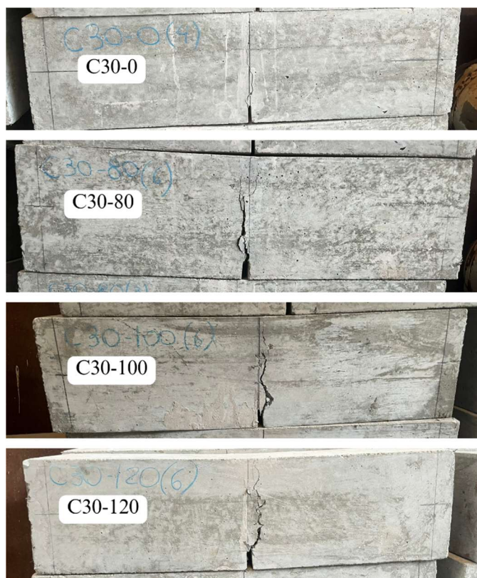
Figura 45 - Aspecto final do grupo C30 após o ensaio
