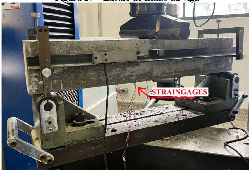
Figura 27 – Ensaio de flexão da viga
