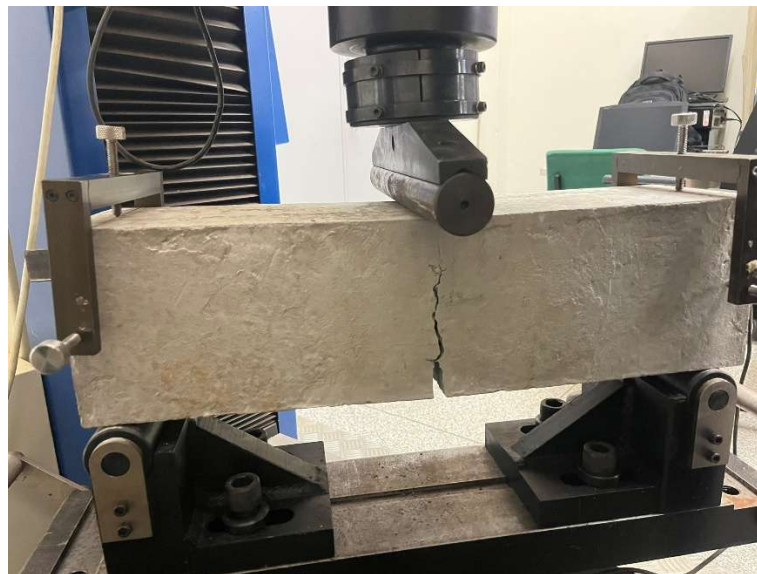
Figura 31 - Ensaio de tração à flexão
