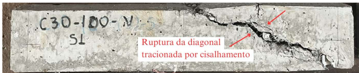
Figura 59 - Panorama de fissuração do grupo C30-100
