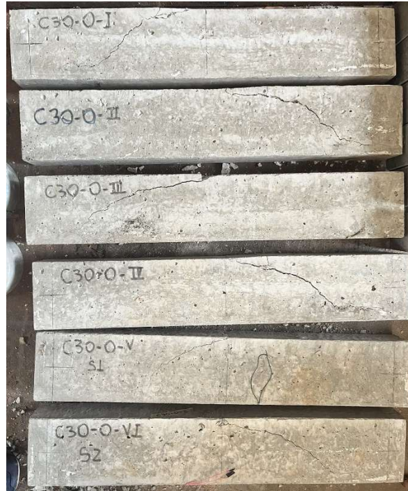
Figura 54 - Aspecto final das vigas do grupo C30-0 após ensaio
