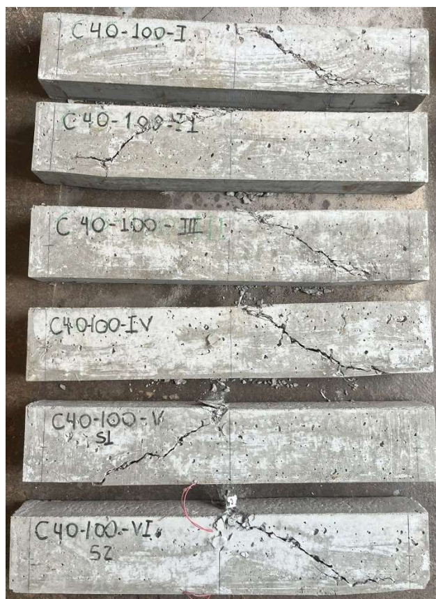
Figura 73 - Aspecto final das vigas do grupo C40-100 após ensaio
