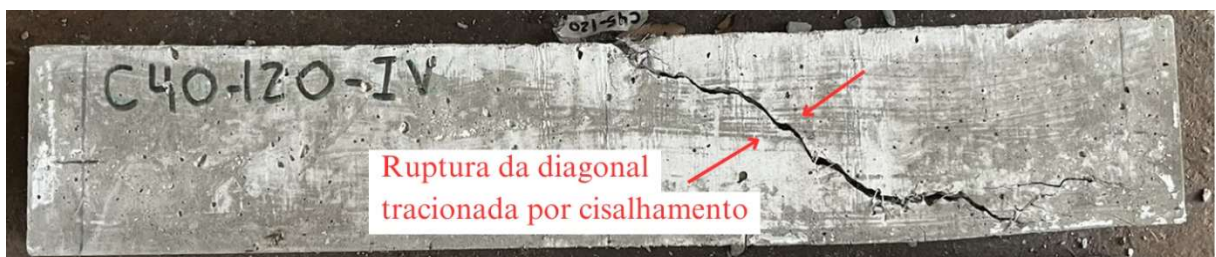
Figura 75 - Panorama de fissuração do grupo C40-120
