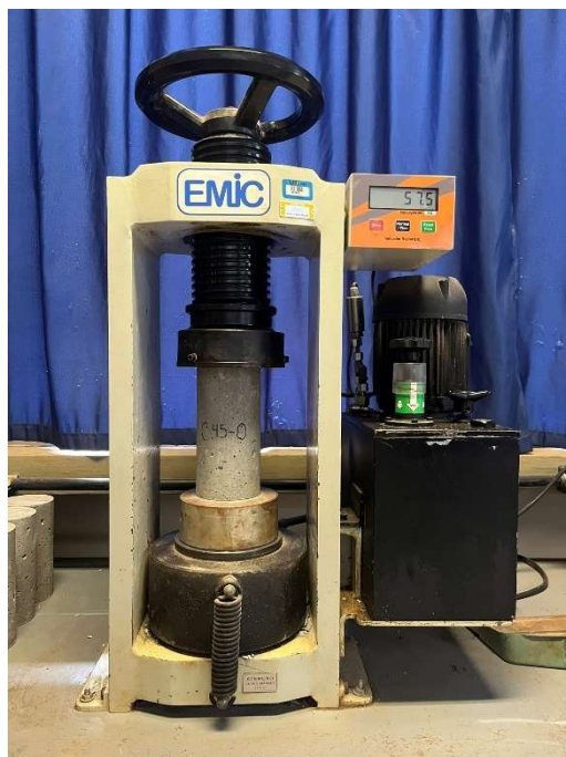
Figura 19 - Execução de Ensaio de Compressão Axial de Corpo Cilíndrico
