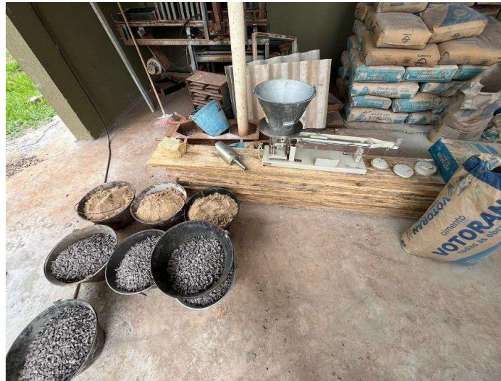
Figura 15 - Dosagem dos materiais e balança mecânica do Laboratório da UTFPR -CM
