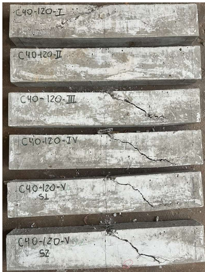
Figura 76 - Aspecto final das vigas do grupo C40-120 após ensaio
