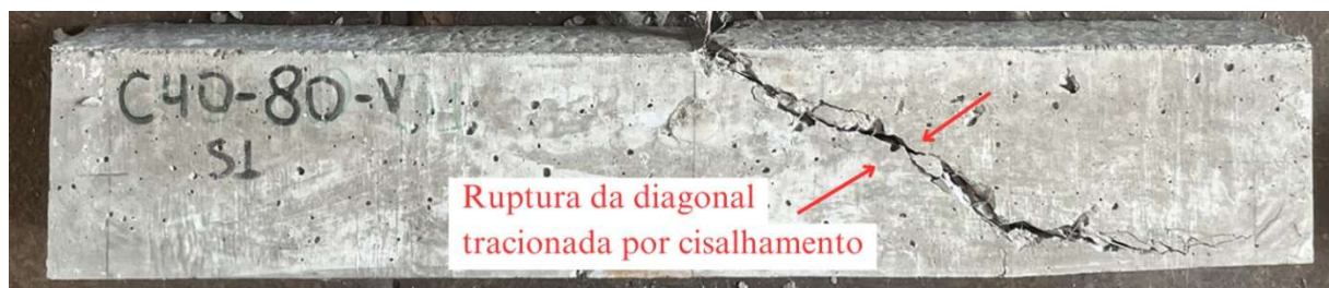
Figura 69 - Panorama de fissuração do grupo C40-80
