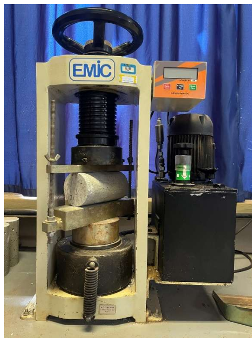
Figura 20 - Execução de Ensaio de Compressão Axial de Corpo Cilíndrico
