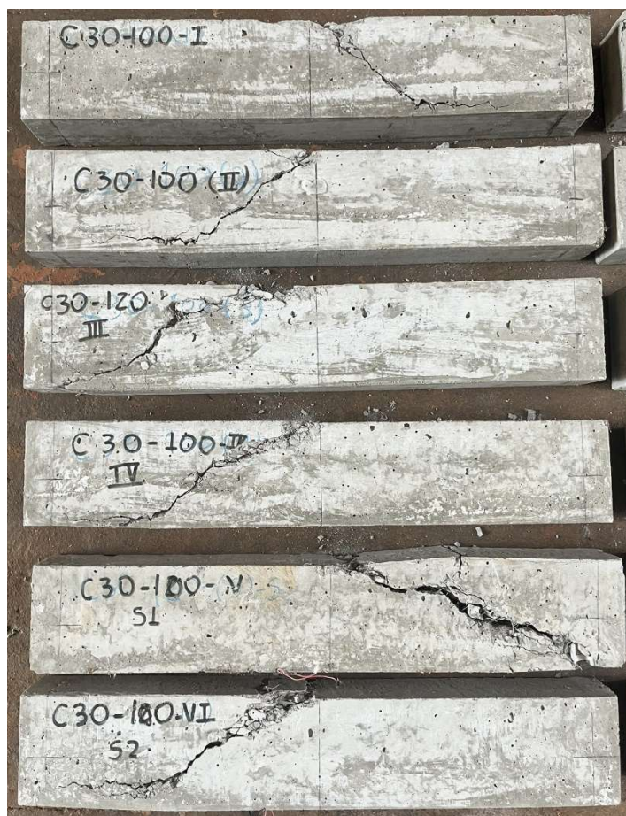
Figura 60 - Aspecto final das vigas do grupo C30-100 após ensaio
