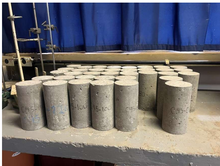
Figura 18 - Corpos de Prova Cilíndricos - Compressão Axial e Diametral
