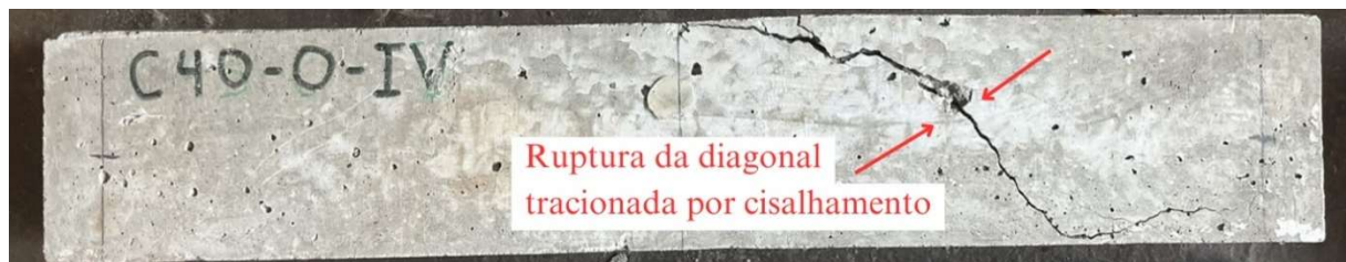
Figura 66 - Panorama de fissuração do grupo C40-0
