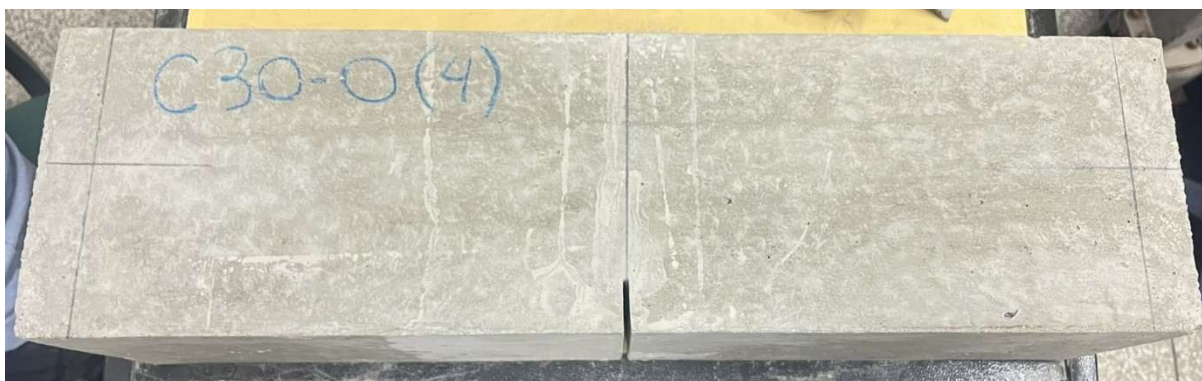
Figura 32 – Corpo de Prova Prismático com Entalhe
