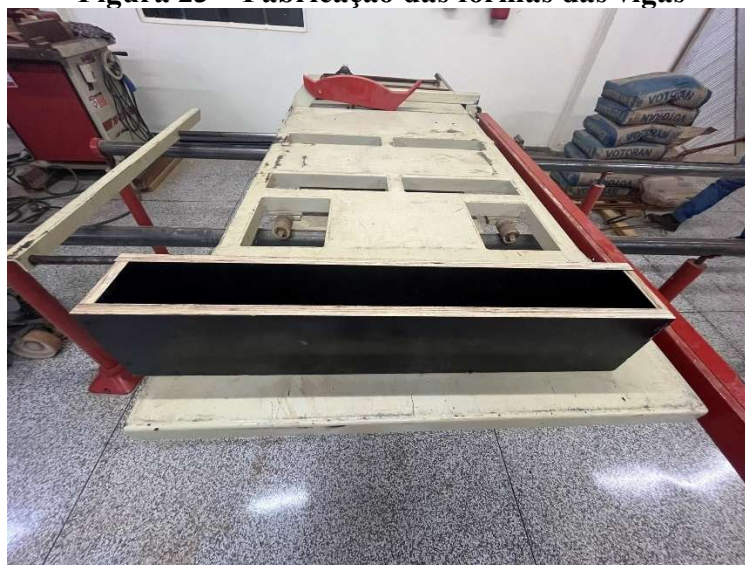
Figura 23 – Fabricação das formas das vigas
