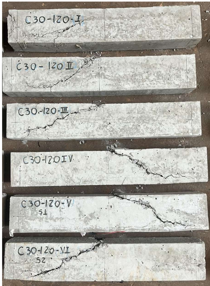
Figura 63 - Aspecto final das vigas do grupo C30-120 após ensaio
