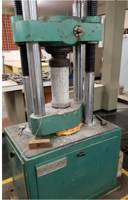
Figura 3.24 - Ensaio de resistência à compressão axial
