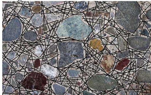
Figura 2.8 - Sistema estrutural do CRF
