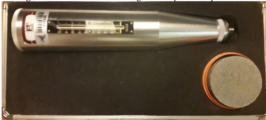
Figura 3.18 - Esclerômetro analógico de impacto do tipo Schmidt
