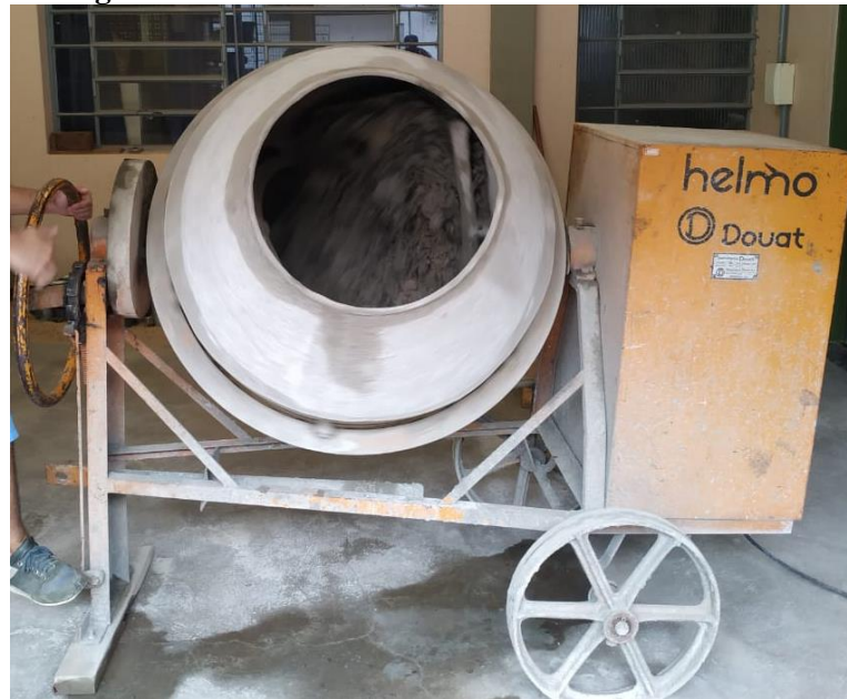
Figura 3.2 - Mistura dos concretos em betoneira elétrica
